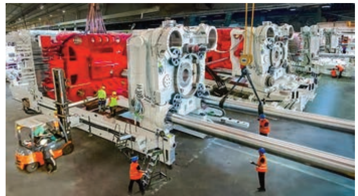
Giga Press en proceso de instalación/montaje (fábrica de Tesla): una de las enormes prensas de 6.000 a 9.000 toneladas utilizadas para el Gigacasting.
