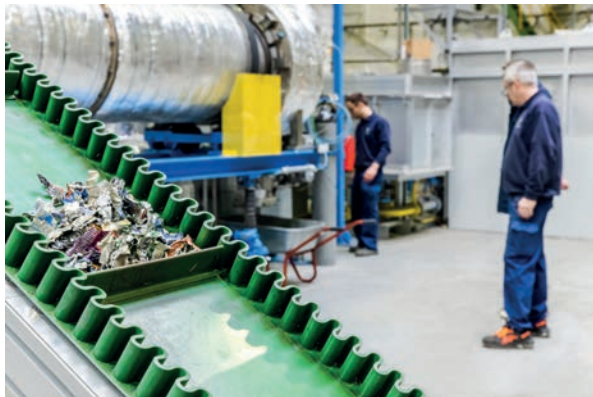
Figuras 6 y 7: Horno rotativo para eliminación de materia orgánica
